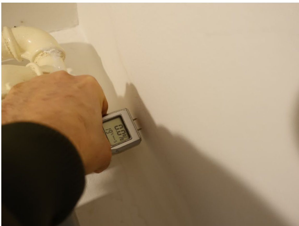
izmjera vlažnosti stropa i zida kod plinomjera 0,0% suho
