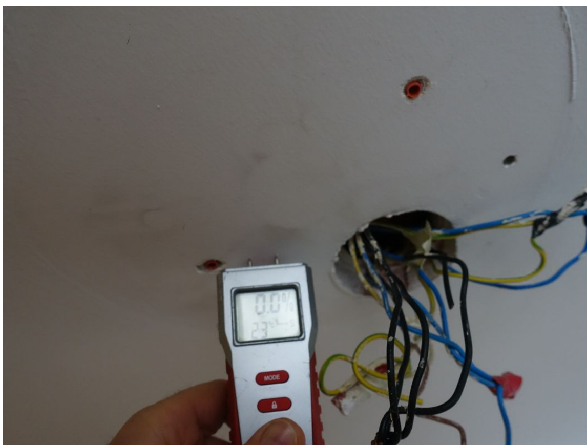
5 izvoda cijevi u stropnoj razvodnoj kutiji, mjerena vlaga 0,0% - suho
